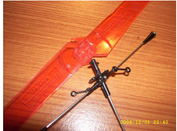
12) Now remove and replace the top rotor.
